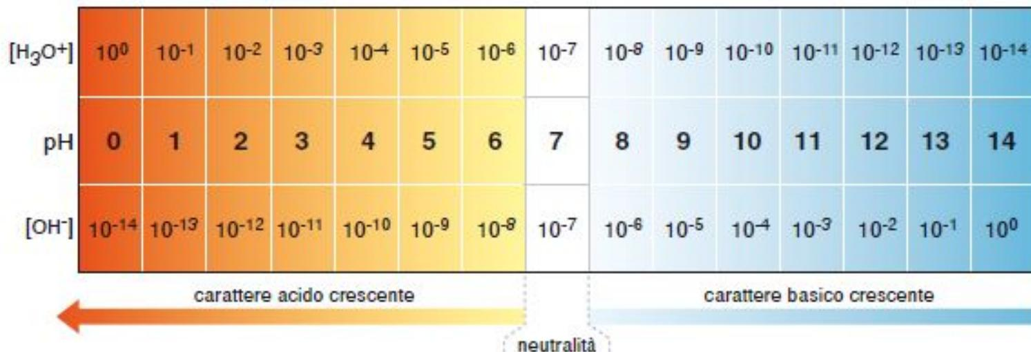
Figura 18.4. Scala del pH in funzione delle concentrazioni di ioni  $H_3O^+$  e ioni  $OH^-$ .
