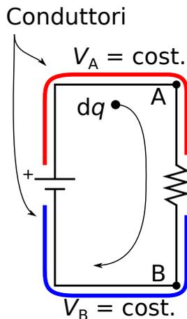
Una resistenza dissipa energia elettrica sotto forma di energia termica (il cosiddetto *effetto Joule*). La quantità di energia termica prodotta per l'unità di tempo è calcolabile dalla potenza dissipata e dalla legge di Ohm:
