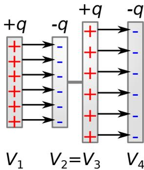
Se colleghiamo due condensatori in serie, le piastre tra i due saranno allo stesso potenziale perché sono un unico conduttore ( $V_2 = V_3$ ). Le cariche accumulate sulle piastre saranno uguali tra di loro, perché non sono fisicamente connesse con le piastre esterne e quindi la carica totale si deve conservare. Essendo la carica iniziale nulla dovrà essere nulla anche dopo che il condensatore è stato caricato. La capacità di un condensatore equivalente sarà
